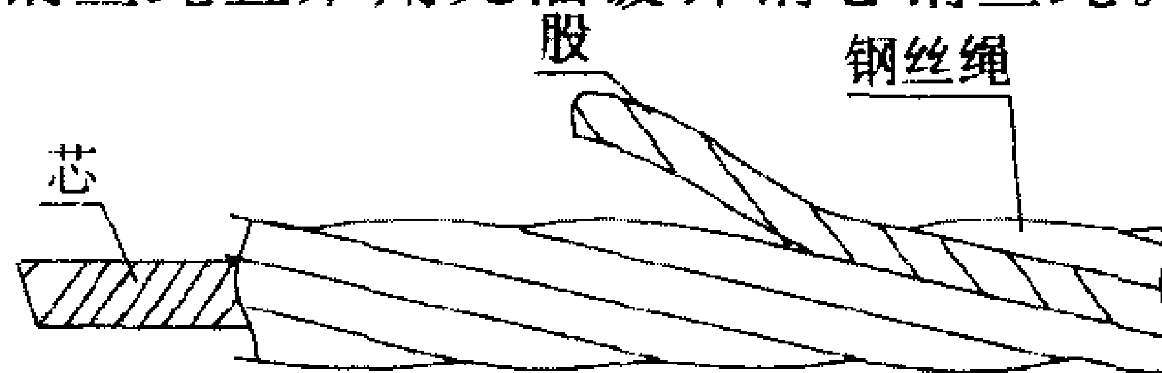
图 4.2.2 钢丝绳结构示意图
